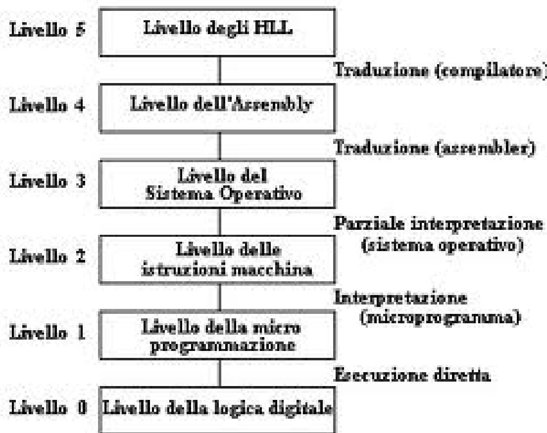
Il livello L0 rappresenta il computer reale ed il linguaggio macchina che esso è in grado di eseguire direttamente. Ogni livello superiore rappresenta una macchina astratta. I programmi (istruzioni) di ogni livello superiore devono essere o tradotti in termini di istruzioni di uno dei livelli inferiori, o interpretati da un programma che gira su di una macchina astratta di livello strettamente inferiore.
