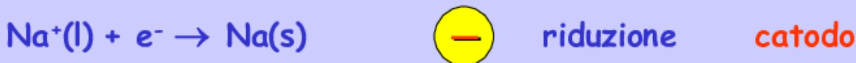
Le definizioni di anodo (elettrodo al quale avviene l'ossidazione) e catodo (elettrodo al quale avviene la riduzione) rimangono le stesse ma in una cella elettrolitica le polarità sono invertite rispetto ad una cella voltaica.
