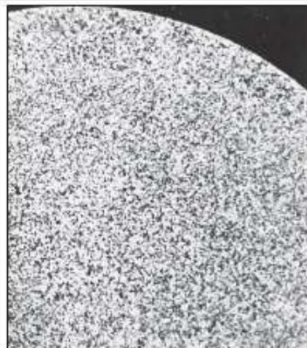
Struttura a grani di alluminio fuso con (a) e senza (b) raffinatori di grano
