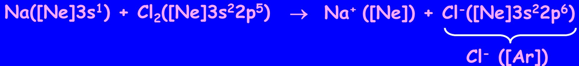
Si noti che in seguito al trasferimento elettronico si ha la formazione di due ioni con configurazione elettronica di un gas nobile
